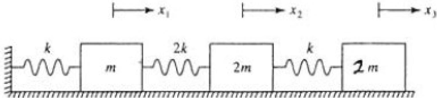
$$\begin{bmatrix} m & 0 & 0 \\ 0 & 2m & 0 \\ 0 & 0 & 2m \end{bmatrix} \begin{bmatrix} \ddot{x}_1 \\ \ddot{x}_2 \\ \ddot{x}_3 \end{bmatrix} + \begin{bmatrix} 3k & -2k & 0 \\ -2k & 3k & -k \\ 0 & -k & k \end{bmatrix} \begin{bmatrix} x_1 \\ x_2 \\ x_3 \end{bmatrix} = \begin{bmatrix} 0 \\ 0 \\ 0 \end{bmatrix}$$
